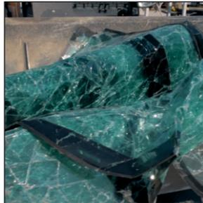
Tehnologia reciclării sticlei presupune etape precise de mărunțire și separare a componentelor non-sticlă, separarea după spectrul de culoare. Tehnologia oferită, combinată, de la mai mulți furnizori, asigură în cazul reciclării parbrizelor auto, eficiență separare a componentei laminată **PVB** de sticlă mărunțită.
